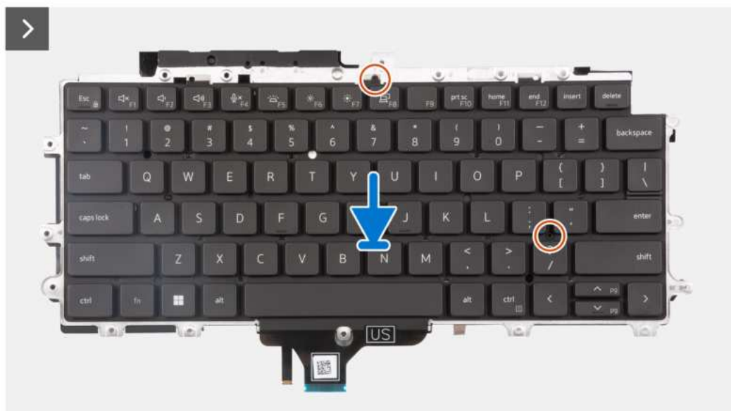
Rysunek 61. Instalowanie zestawu klawiatury
