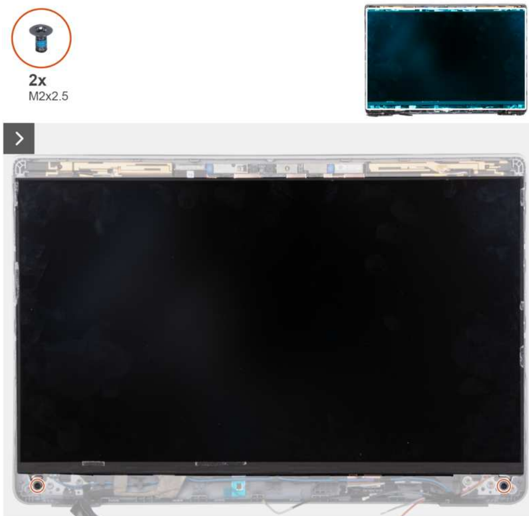
Rysunek 72. Wymontowywanie panelu wyświetlacza (notebook)
