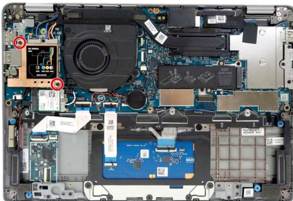
Rysunek 33. Metalowa osłona karty sieci WWAN
