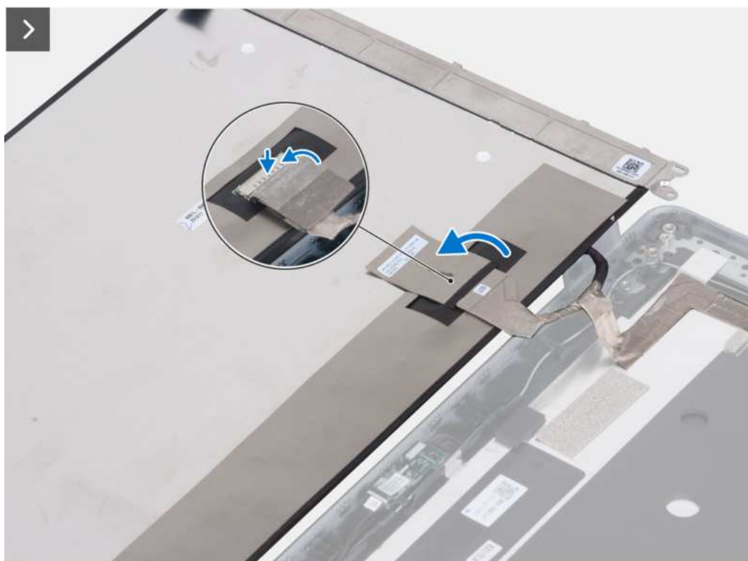
Rysunek 77. Instalowanie panelu wyświetlacza (notebook)
