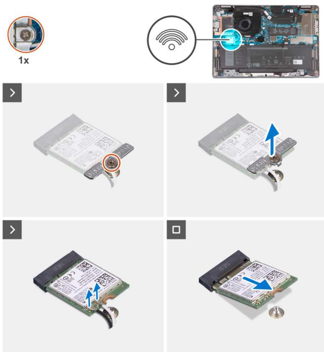
Rysunek 25. Wymontuj kartę sieci bezprzewodowej.
