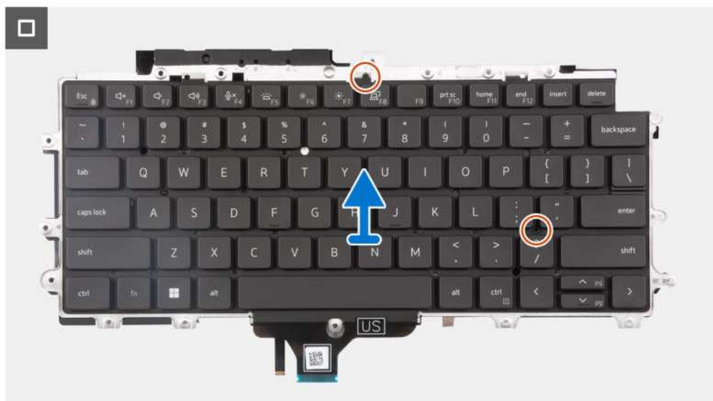
Rysunek 60. Wymontowywanie zestawu klawiatury
