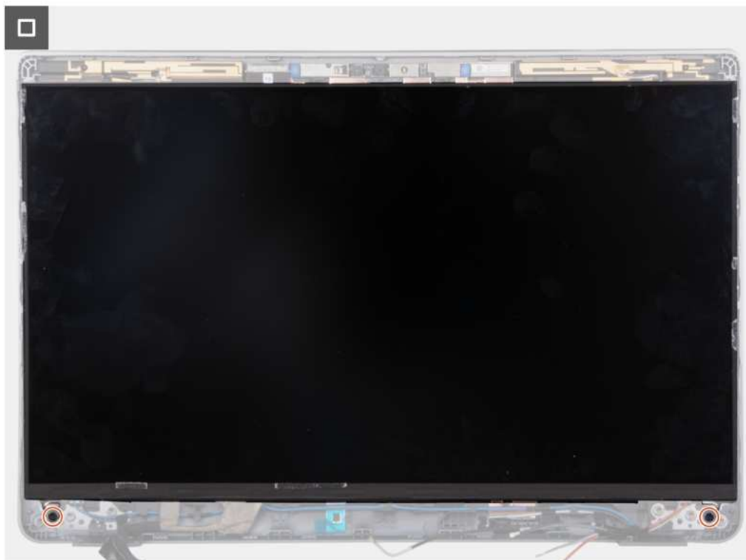
Rysunek 79. Umieszczanie zaczepów panelu wyświetlacza w szczelinach w pokrywie wyświetlacza
