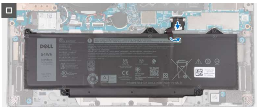
Rysunek 19. Odłącz kabel baterii od płyty głównej
