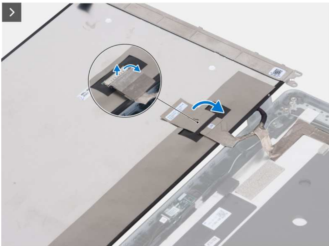
Rysunek 75. Wymontowywanie panelu wyświetlacza (notebook)
