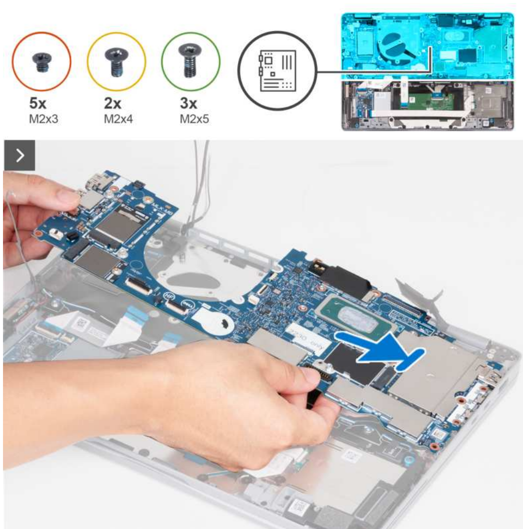
Rysunek 49. Instalowanie płyty głównej
