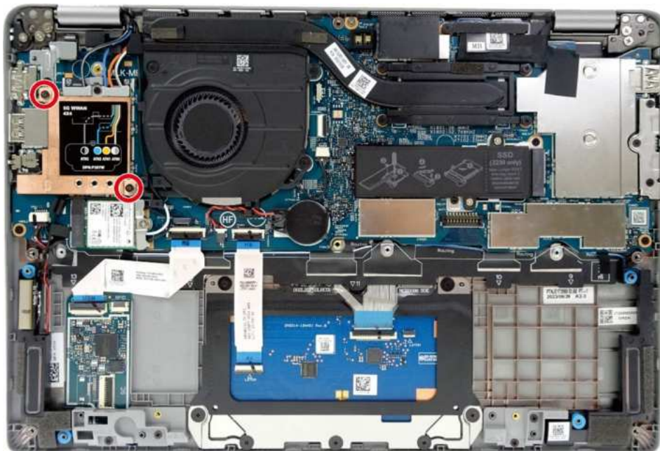
Rysunek 31. Metalowa osłona karty sieci WWAN
