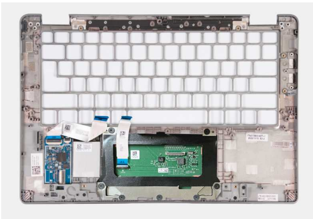
Rysunek 92. Wymontowywanie podpórki na nadgarstek
