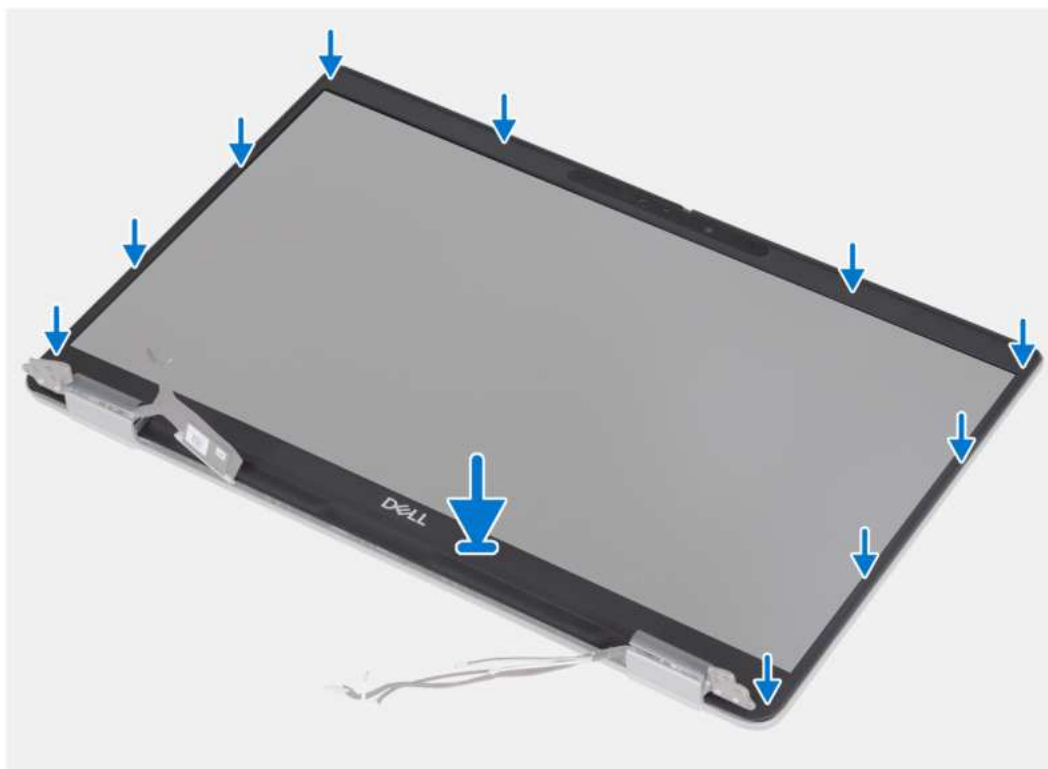
Rysunek 69. Instalowanie ramki wyświetlacza (notebook)
