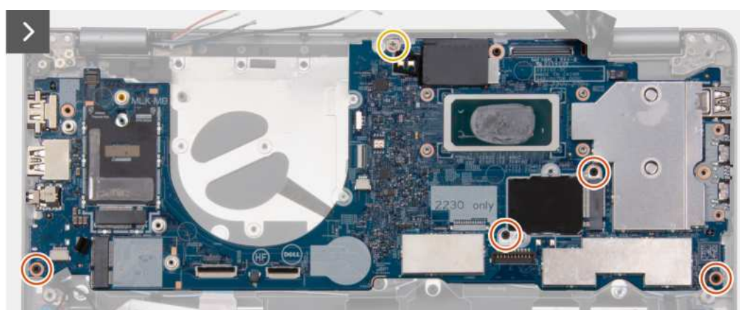
Rysunek 46. Wymontowywanie płyty głównej
