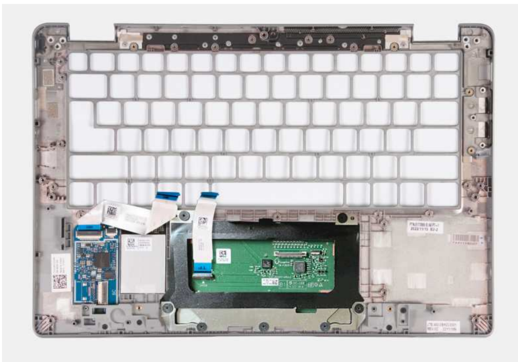
Rysunek 93. Instalowanie podpórki na nadgarstek
