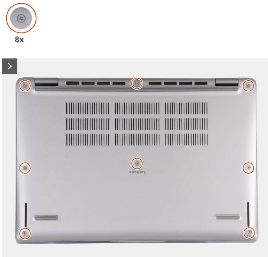
Rysunek 17. Luzowanie ośmiu śrub mocujących pokrywę dolną do zestawu podpórki na nadgarstek
