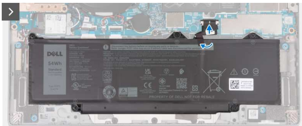
Rysunek 20. Podłączanie kabla baterii do płyty głównej
