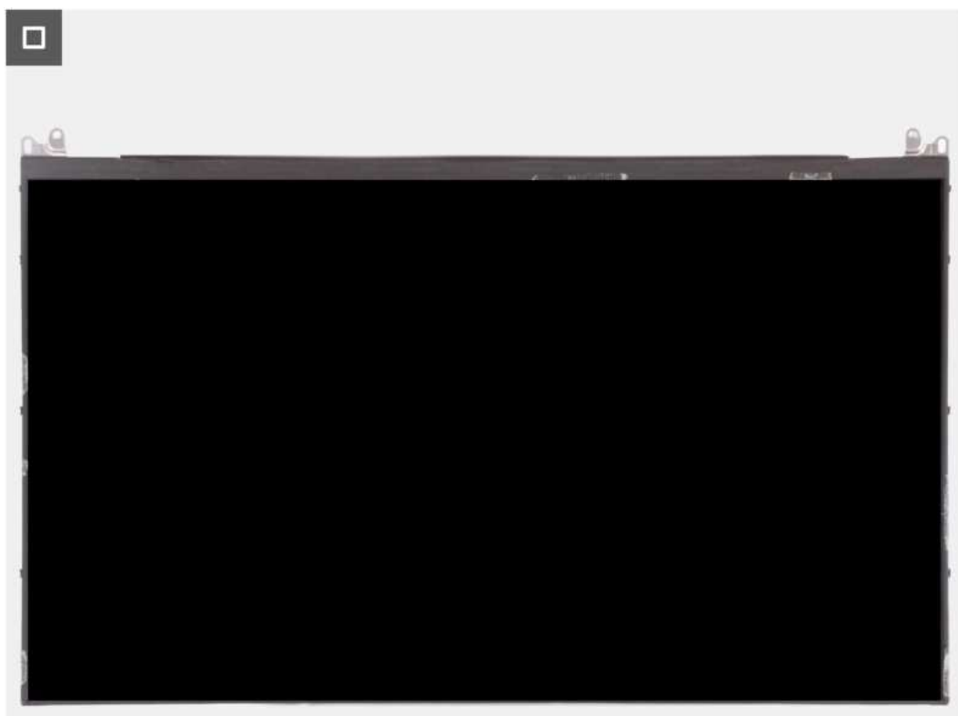
Rysunek 76. Wymontowywanie panelu wyświetlacza (notebook)
