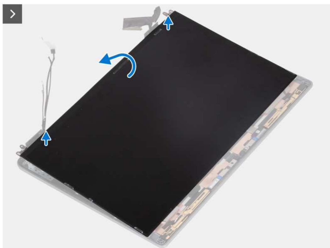
Rysunek 74. Wymontowywanie panelu wyświetlacza (notebook)
