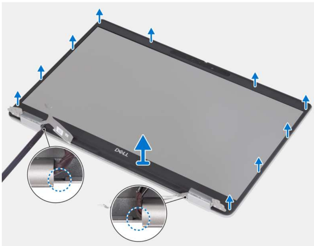
Rysunek 67. Wymontowywanie ramki wyświetlacza (notebook)
