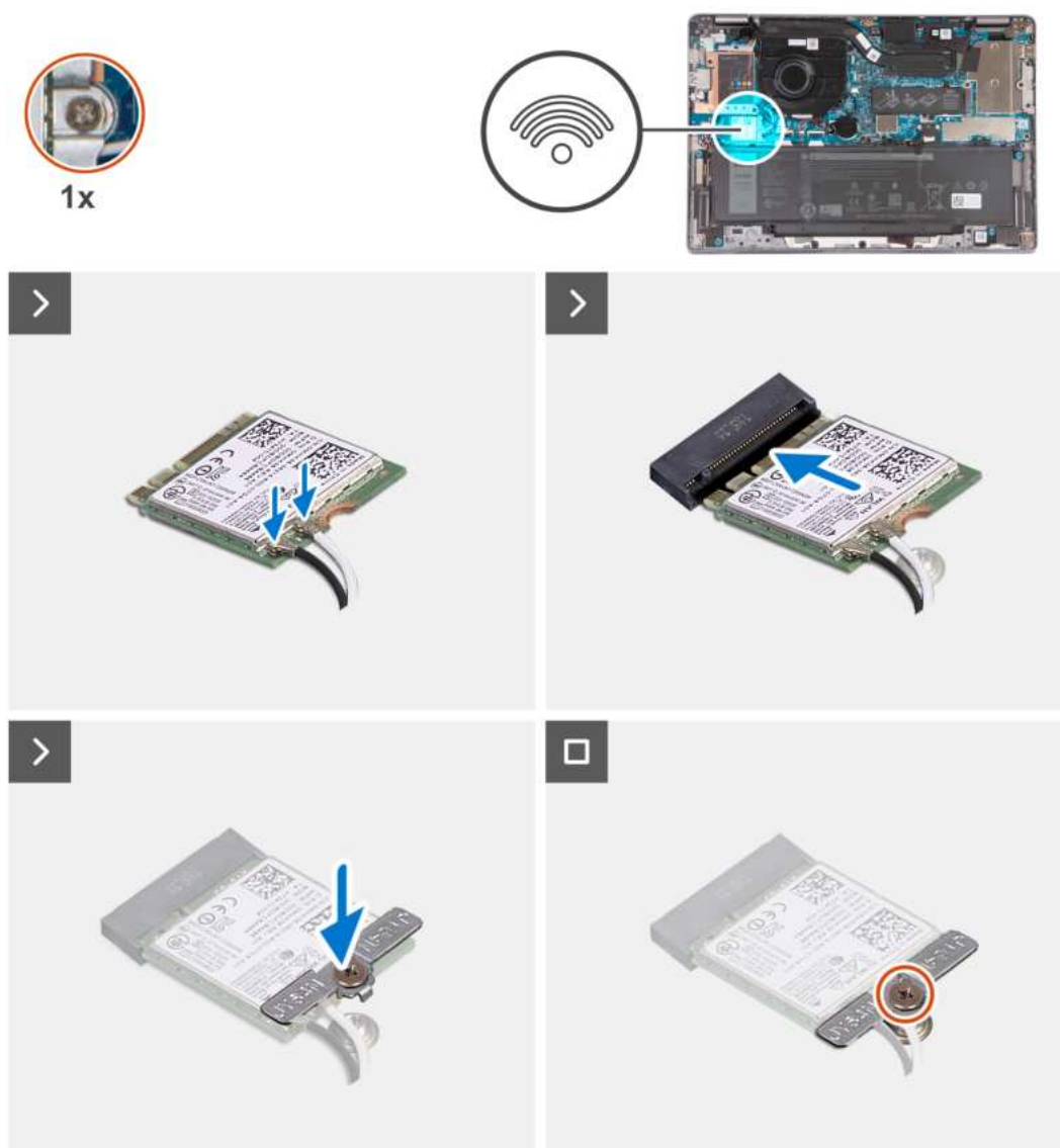
Rysunek 26. Instalowanie karty sieci bezprzewodowej
