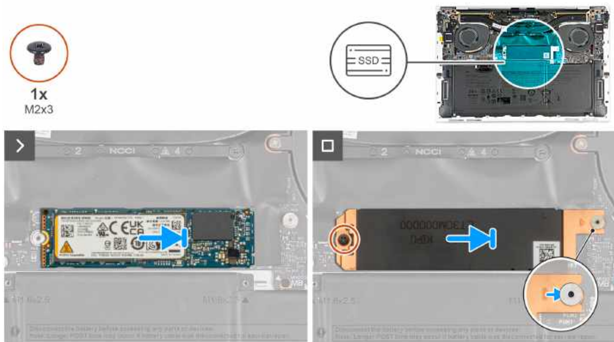
Rysunek 33. Instalowanie dysku SSD M.2 2280
