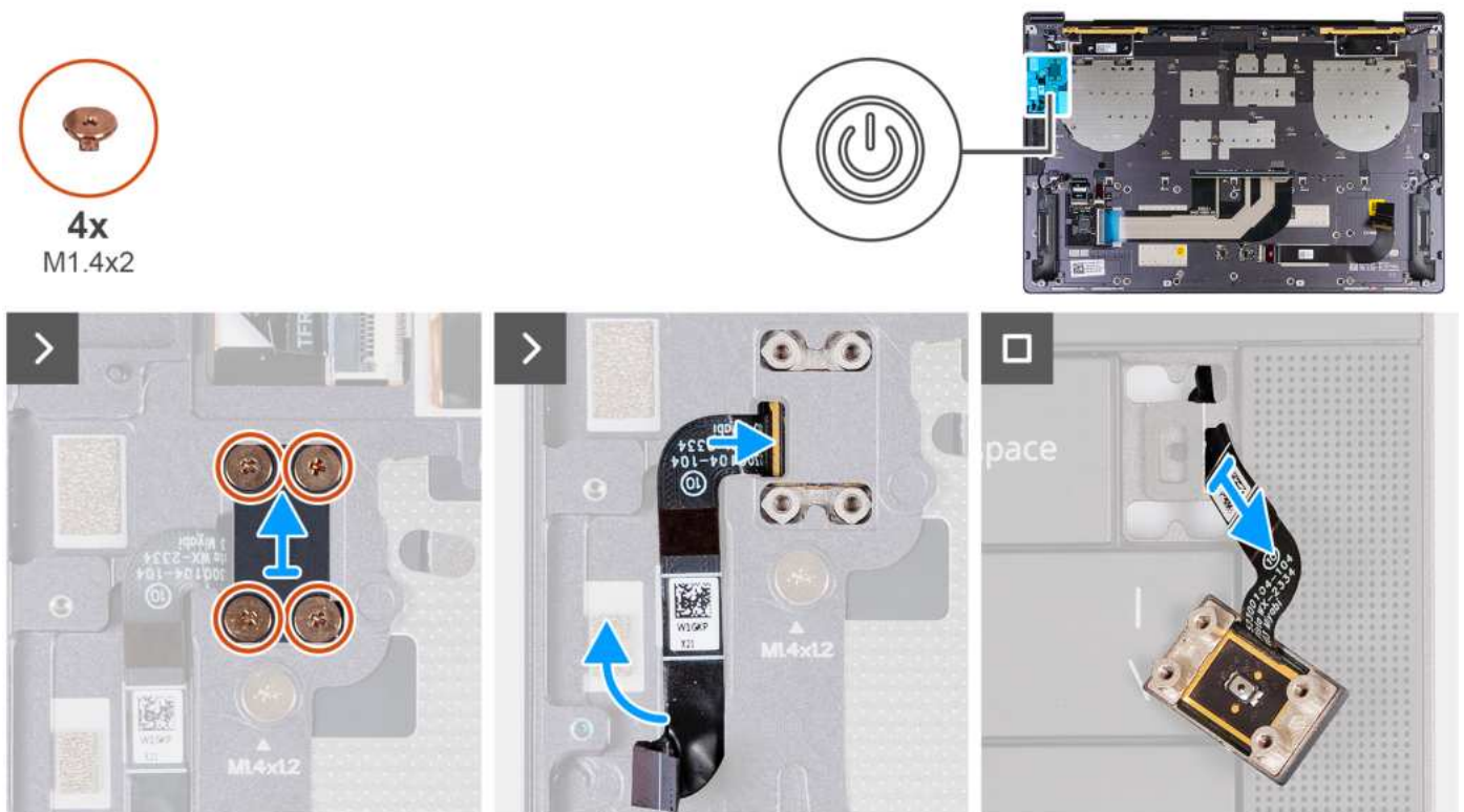
Rysunek 38. Wymontowywanie przycisku zasilania z czytnikiem linii papilarnych
