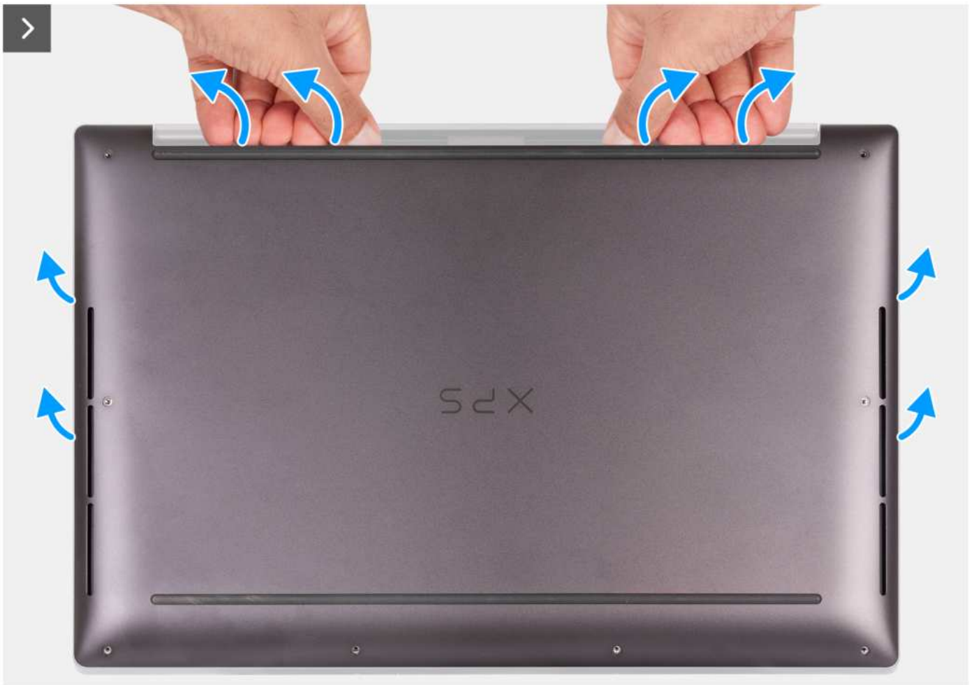
Rysunek 10. Podważanie pokrywy dolnej za pomocą kciuków
