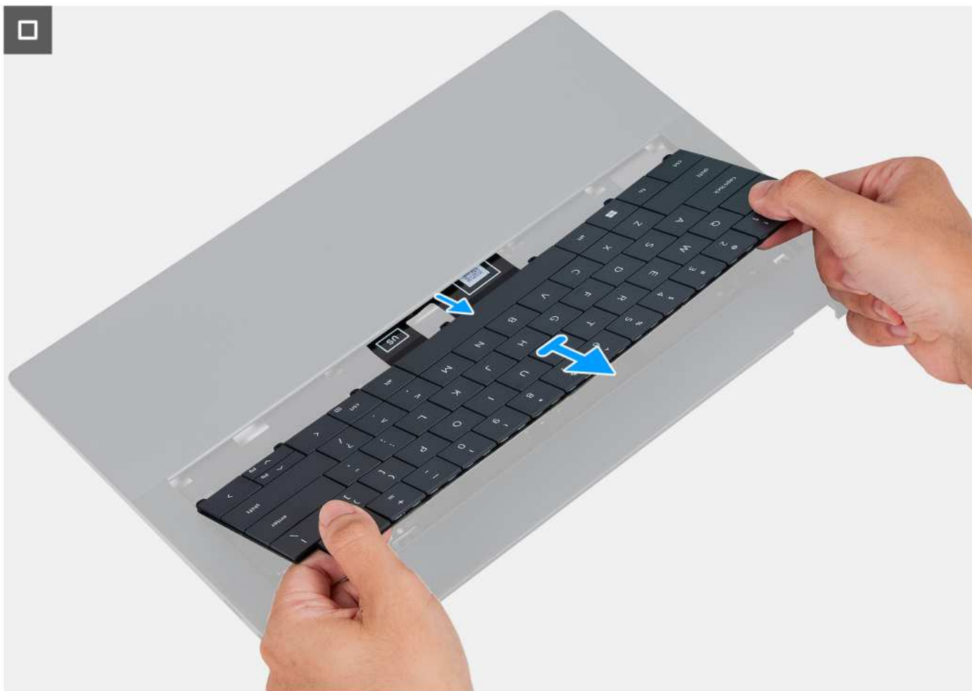
Rysunek 42. Wymontowywanie klawiatury
