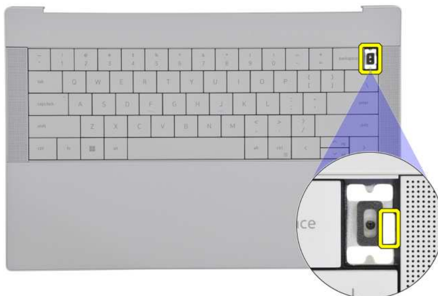
Rysunek 39. Przycisk zasilania z czytnikiem linii papilarnych
