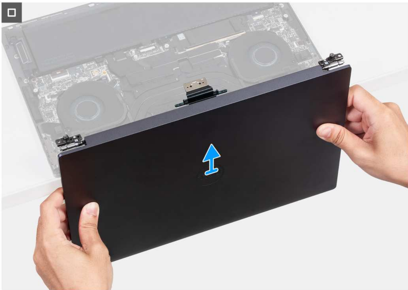
Rysunek 28. Wymontowywanie zestawu wyświetlacza
