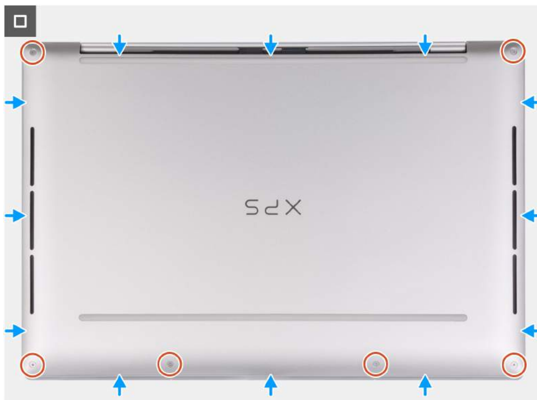
Rysunek 18. Instalowanie pokrywy dolnej
