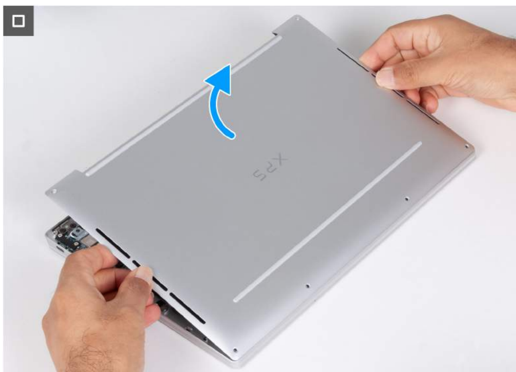
Rysunek 16. Wymontowywanie pokrywy dolnej
