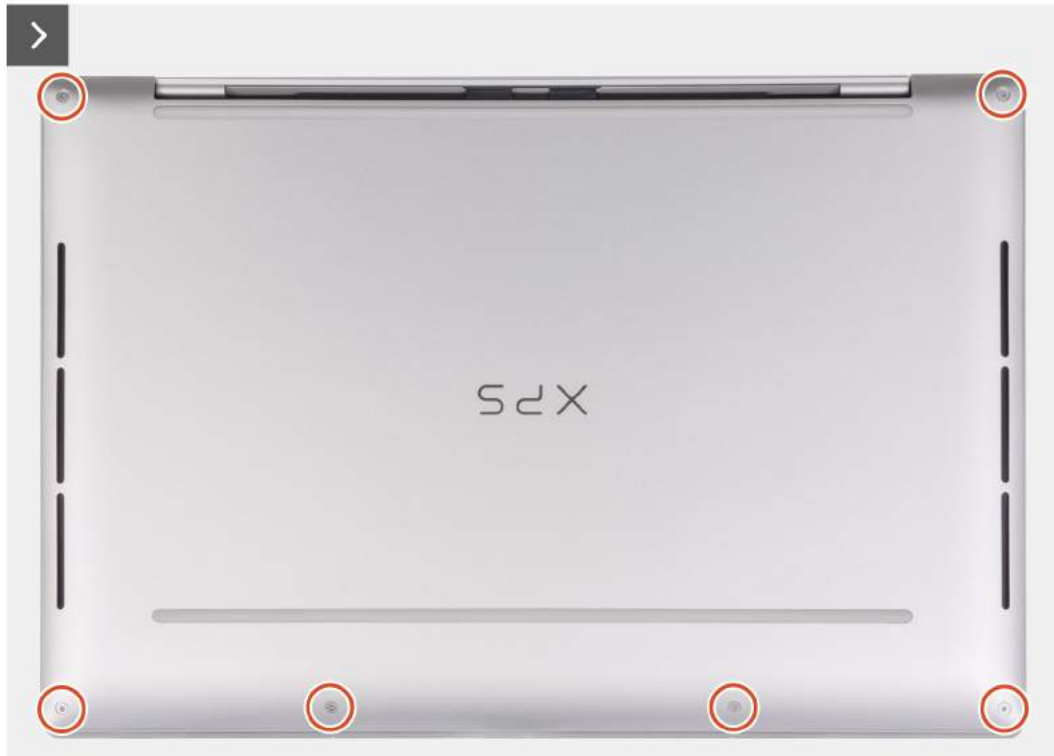
Rysunek 14. Wymontowywanie pokrywy dolnej
