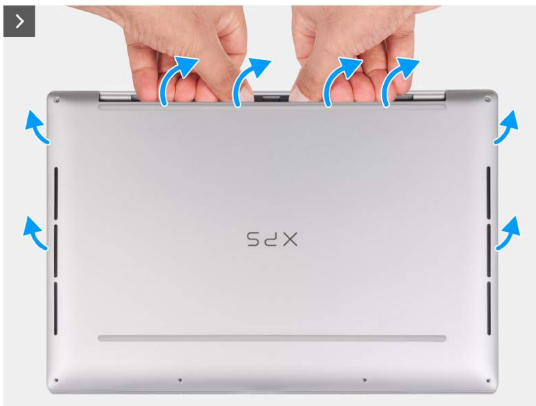
Rysunek 15. Wymontowywanie pokrywy dolnej
