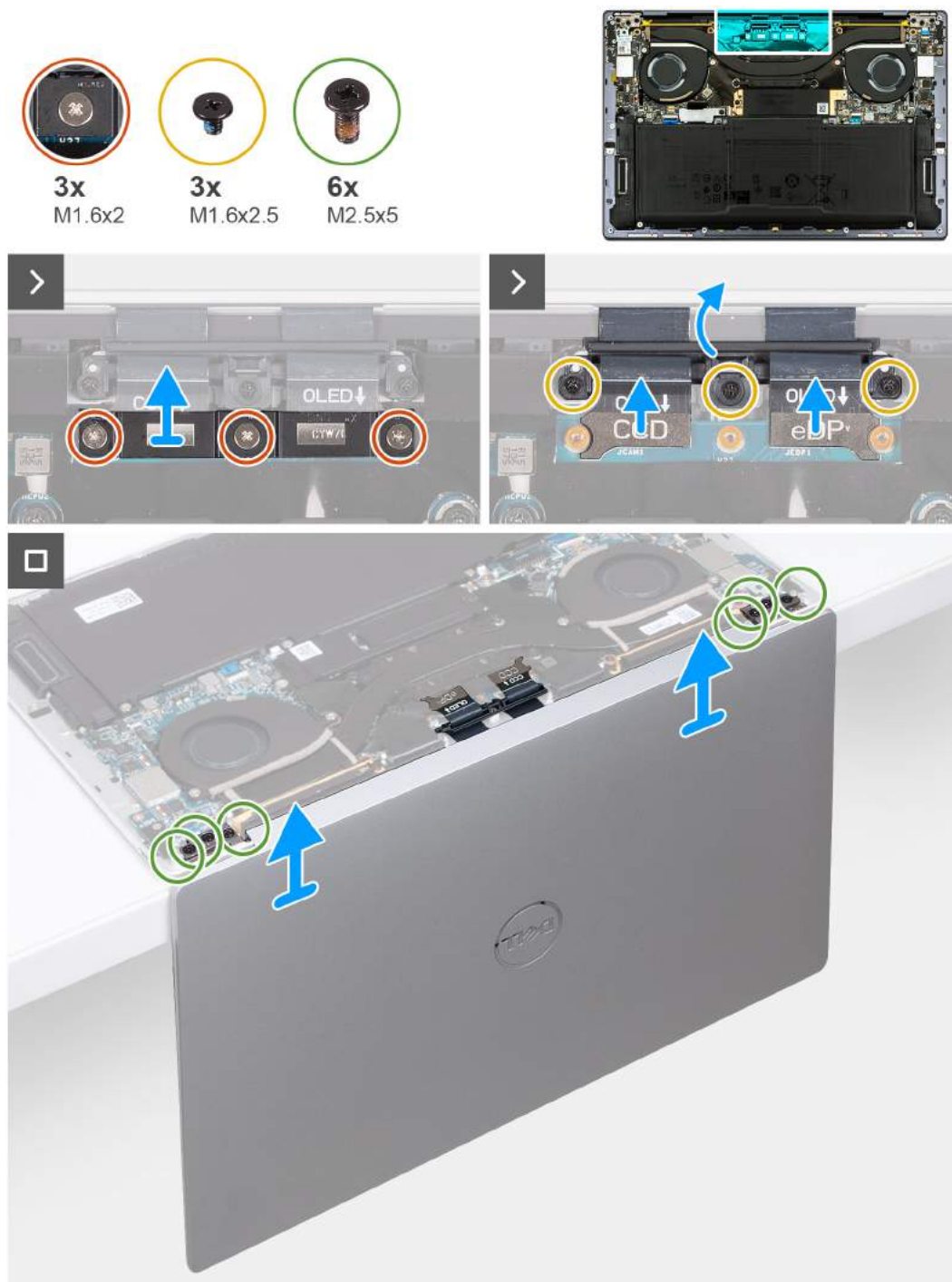
Rysunek 35. Wymontowywanie zestawu wyświetlacza
