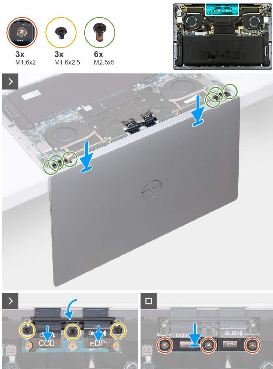
Rysunek 36. Instalowanie zestawu wyświetlacza
