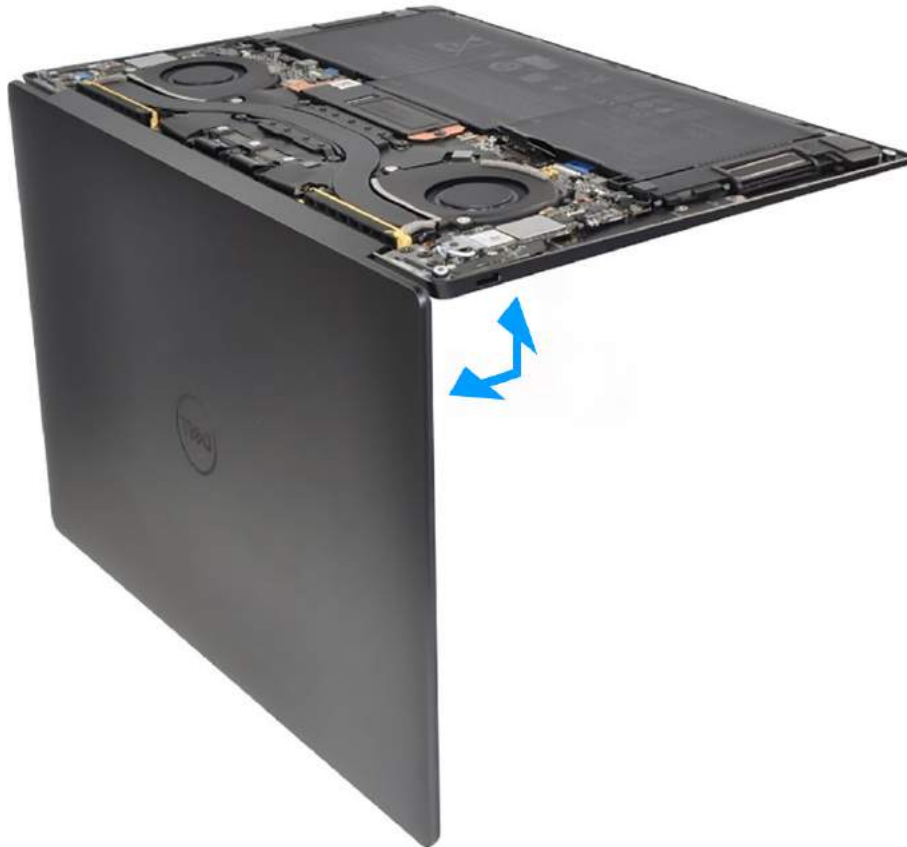
Rysunek 44. Otwieranie zestawu wyświetlacza pod kątem 90 stopni
