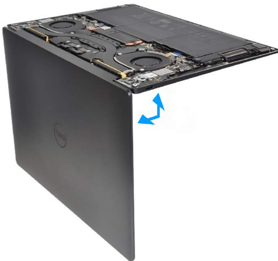
Rysunek 40. Otwieranie zestawu wyświetlacza pod kątem 90 stopni
