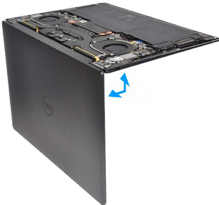
Rysunek 48. Otwieranie zestawu wyświetlacza pod kątem 90 stopni
