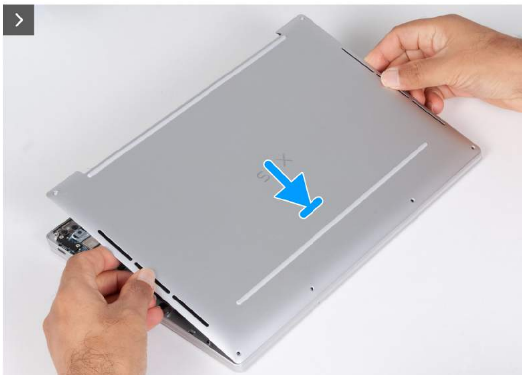
Rysunek 17. Instalowanie pokrywy dolnej
