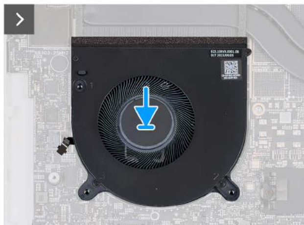
Rysunek 23. Instalowanie wentylatora karty graficznej
