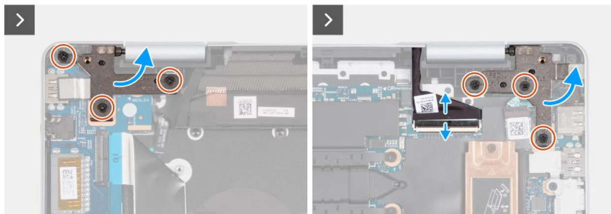
Rysunek 31. Wymontowywanie zestawu wyświetlacza (1)
