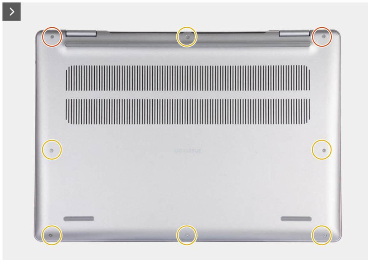
Rysunek 9. Wymontowywanie pokrywy dolnej
