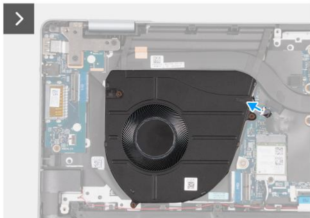
Rysunek 17. Wymontowywanie wentylatora
