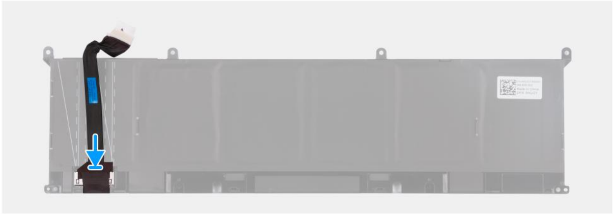
Rysunek 28. Instalowanie kabla baterii 90 Wh
