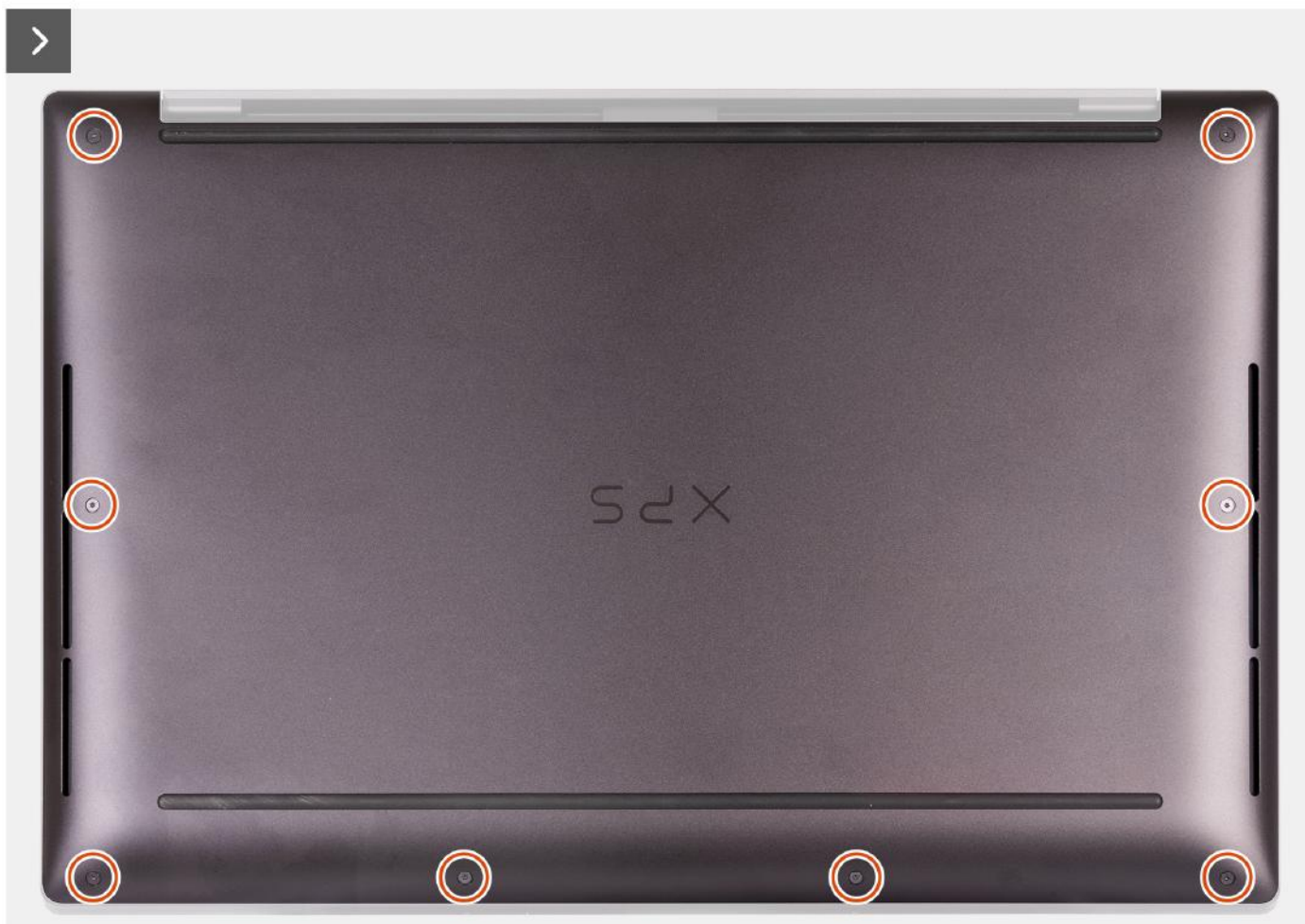
Rysunek 9. Wymontowywanie pokrywy dolnej
