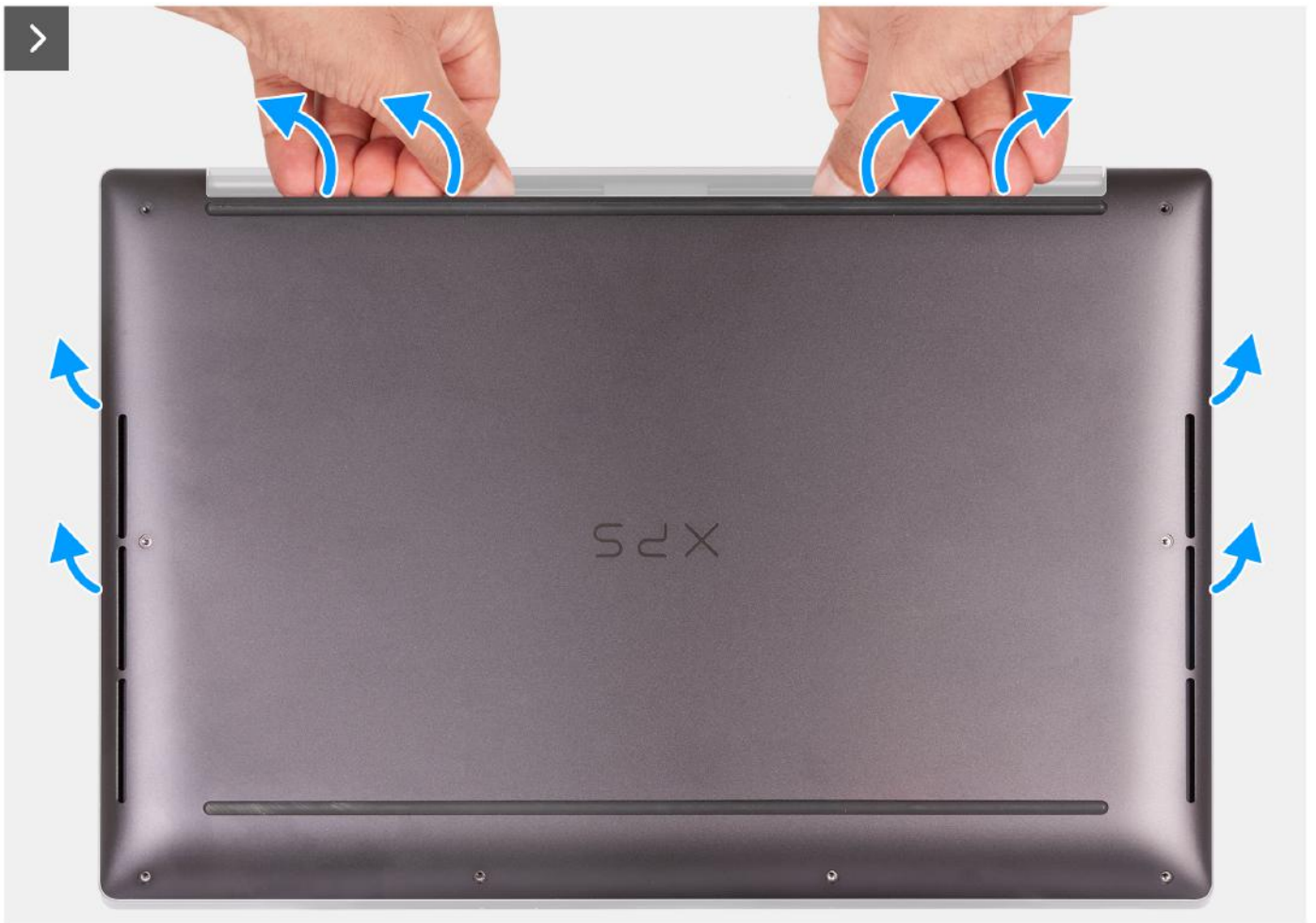
Rysunek 10. Podważanie pokrywy dolnej za pomocą kciuków
