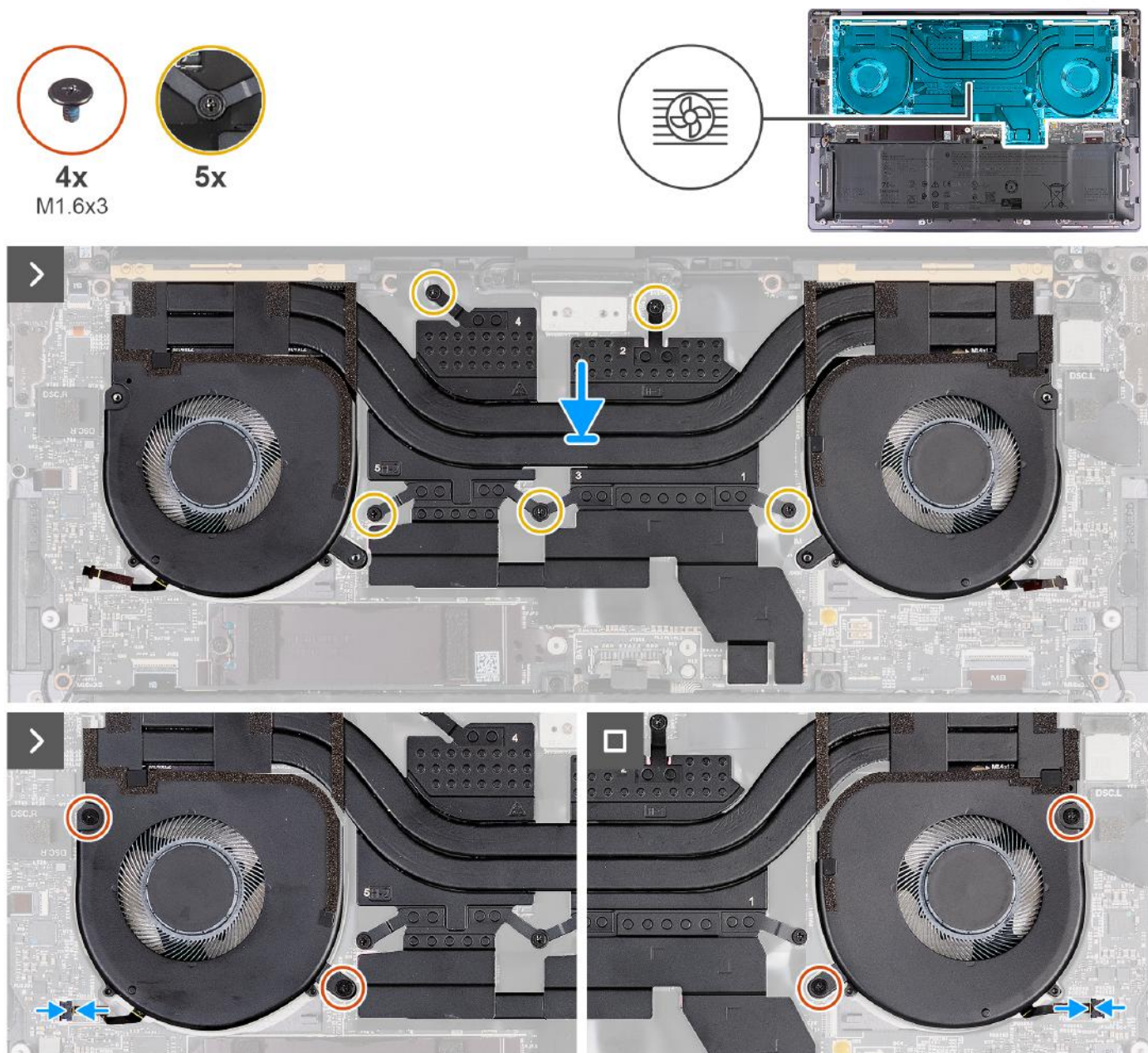
Rysunek 26. Instalowanie zestawu radiatora
