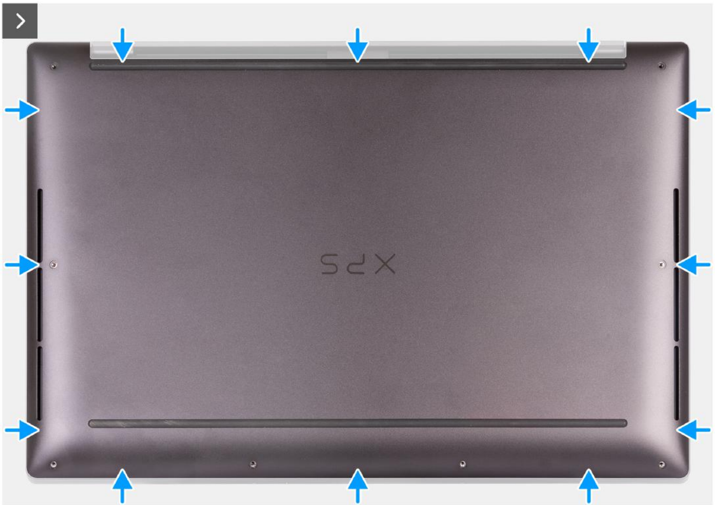
Rysunek 15. Umieść pokrywę dolną na zestawie podpórki na nadgarstek i wciśnij ją na miejsce
