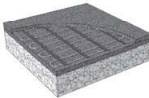
Kabel MA ICE-30 w asfalcie
