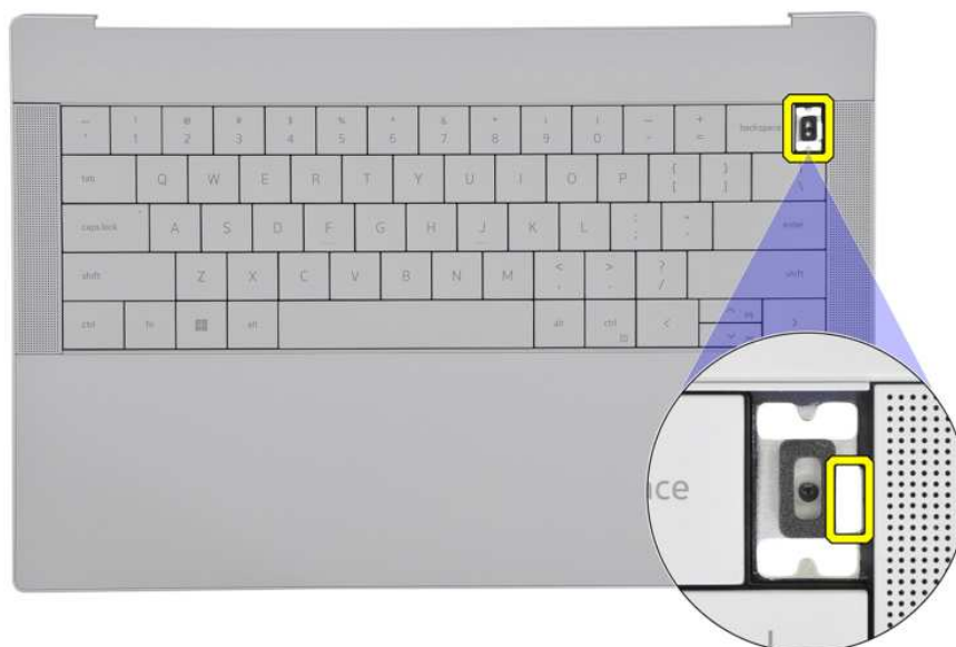
Rysunek 39. Przycisk zasilania z czytnikiem linii papilarnych
