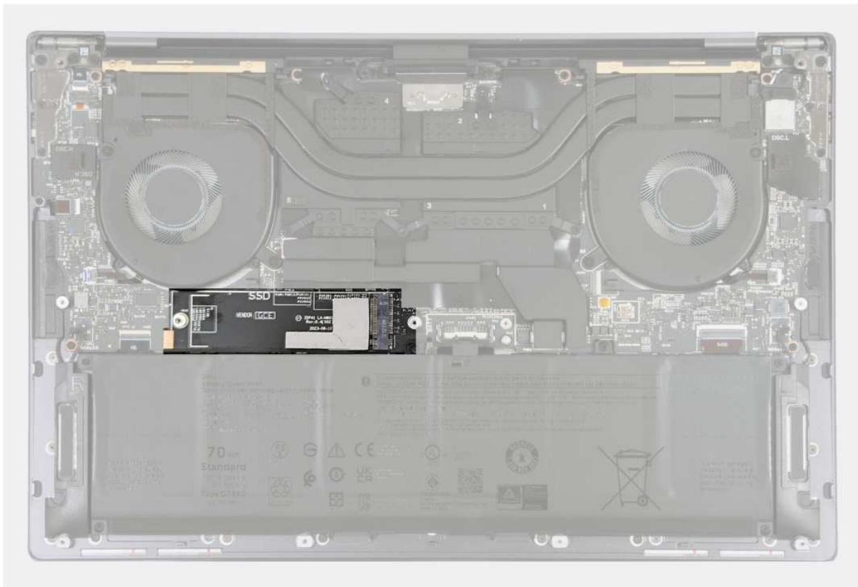
Rysunek 20. Podkładka termoprzewodząca dysku SSD M.2
