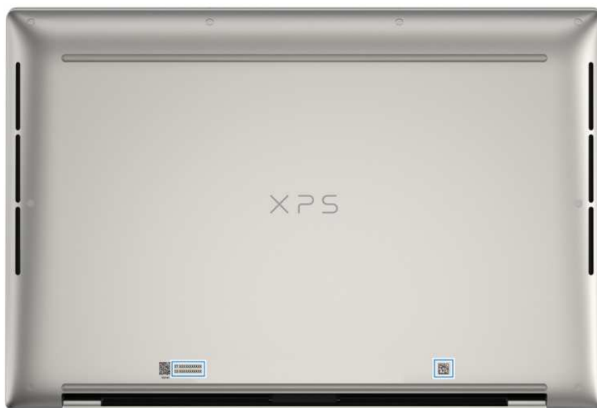
Rysunek 7. Umieszczenie kodu Service Tag
