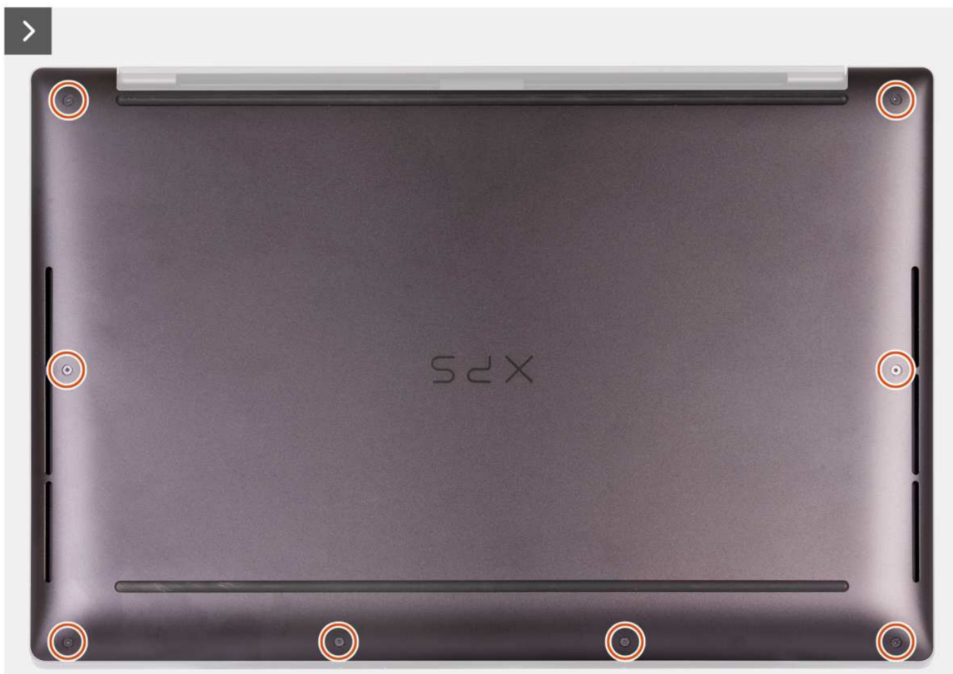
Rysunek 9. Wymontowywanie pokrywy dolnej
