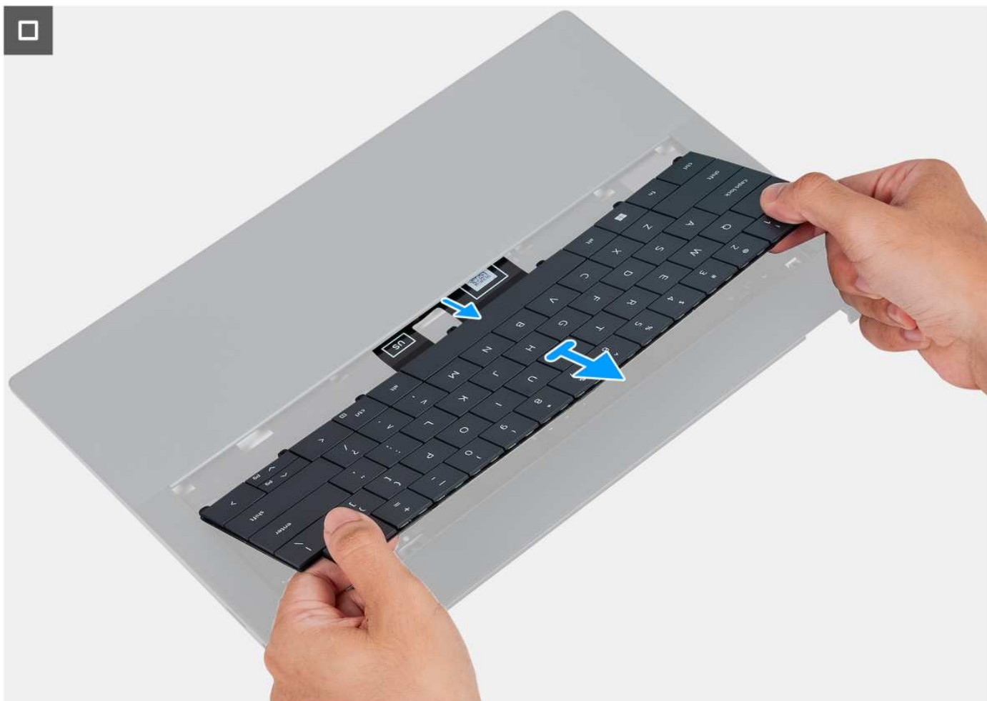
Rysunek 42. Wymontowywanie klawiatury
