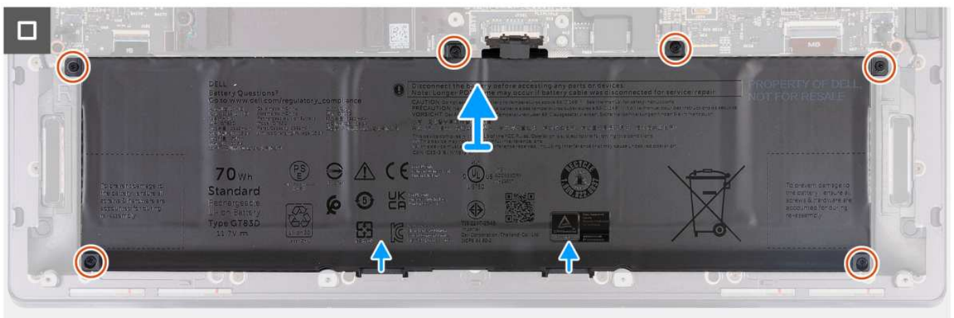
Rysunek 17. Wymontowywanie baterii
