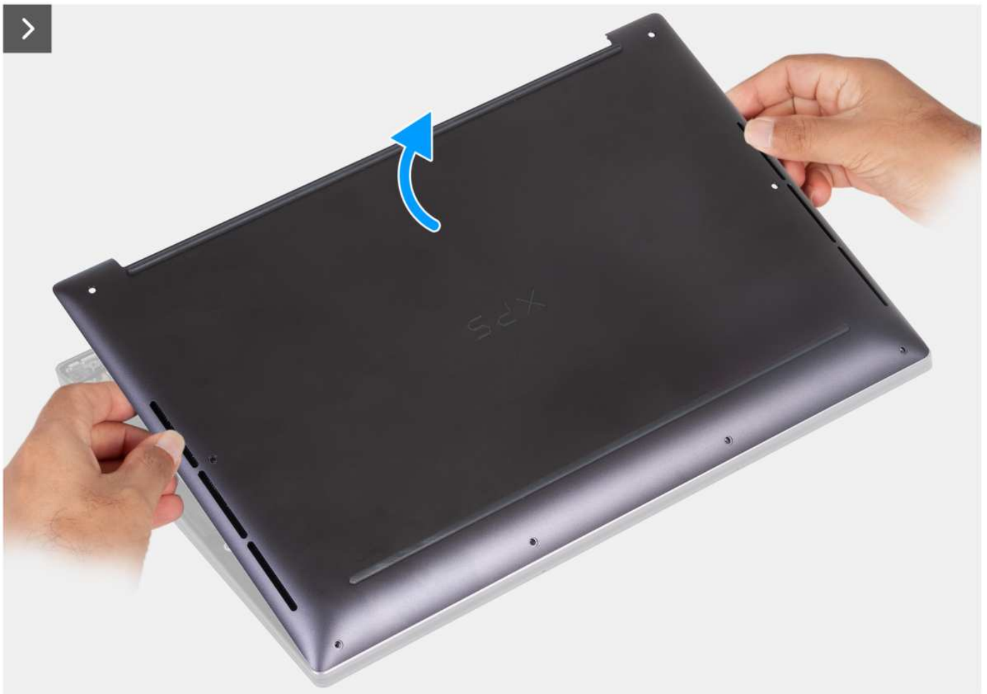
Rysunek 11. Zdejmowanie pokrywy dolnej z zestawu podpórki na nadgarstek
