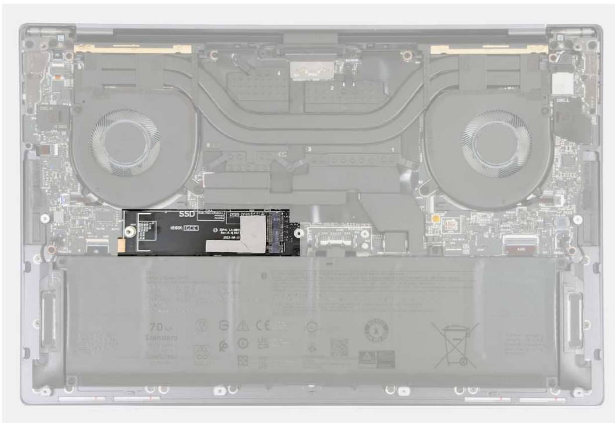
Rysunek 24. Podkładka termoprzewodząca dysku SSD M.2
