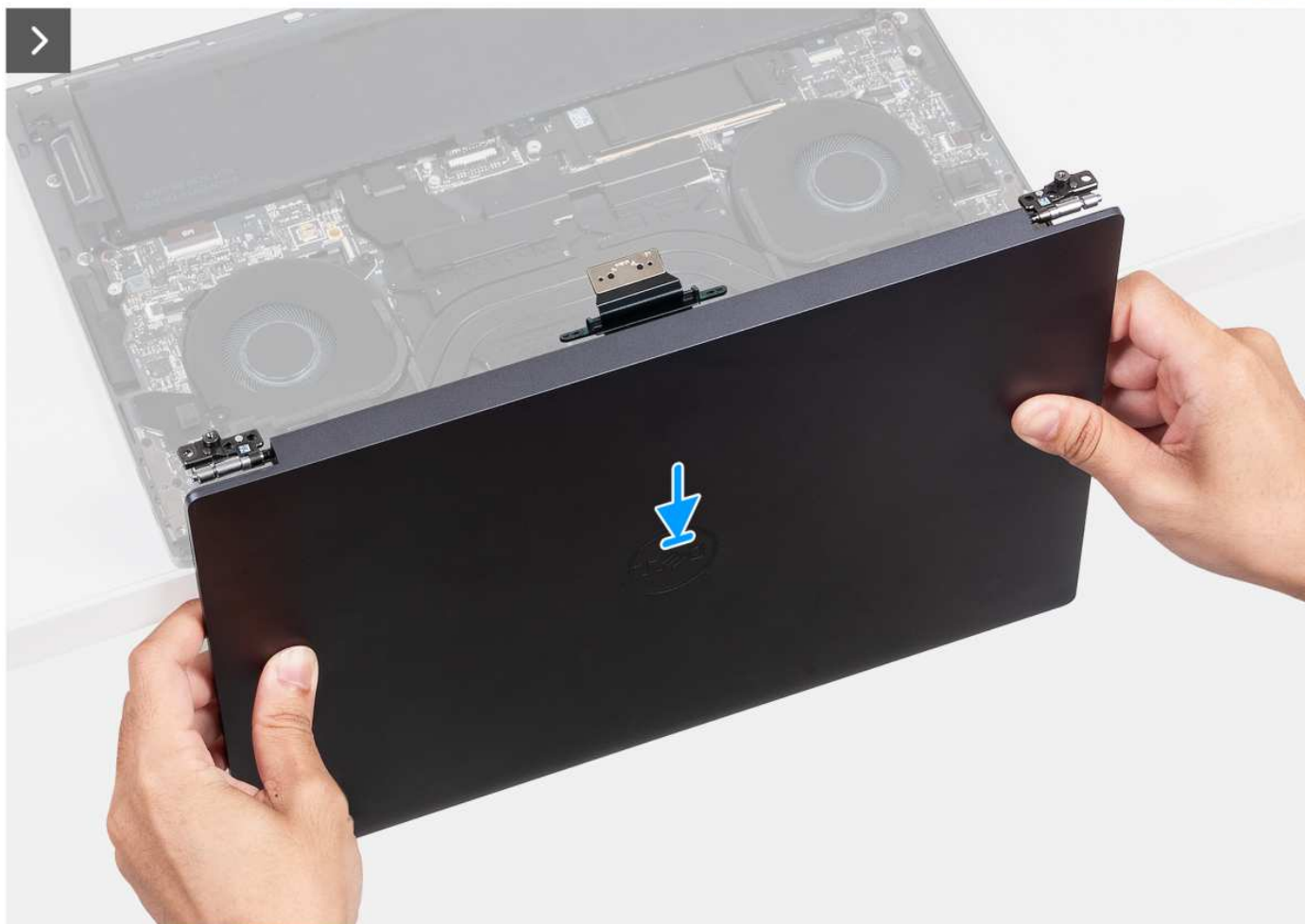
Rysunek 30. Instalowanie zestawu wyświetlacza
