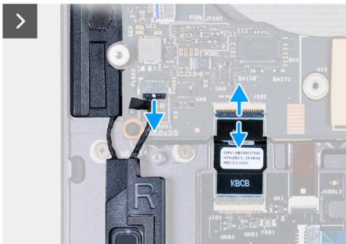
Rysunek 33. Wymontowywanie płyty głównej
