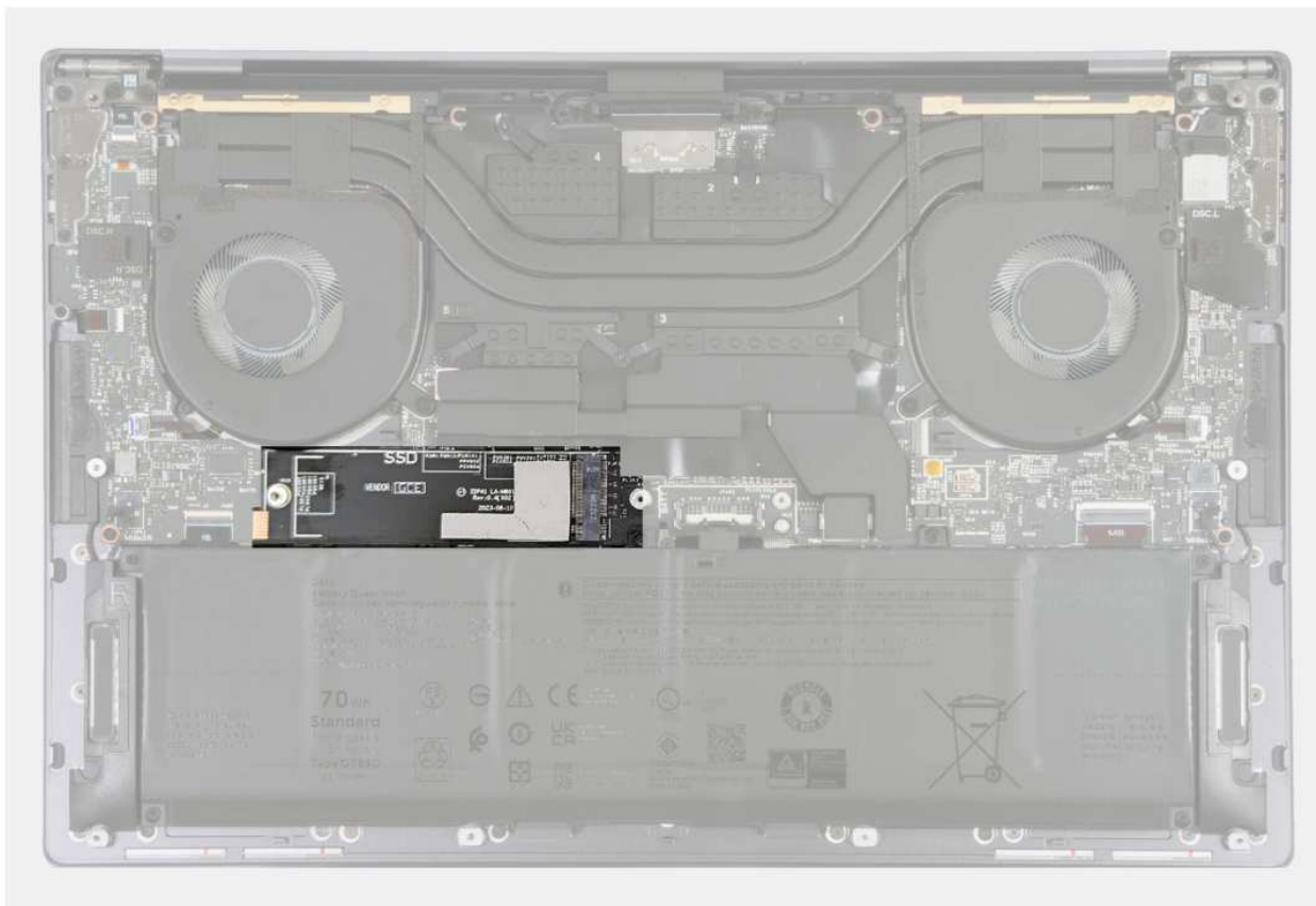
Rysunek 19. Podkładka termoprzewodząca dysku SSD M.2
