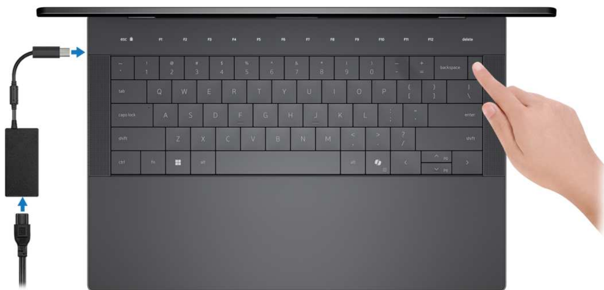
Rysunek 8. Podłącz zasilacz i naciśnij przycisk zasilania.
