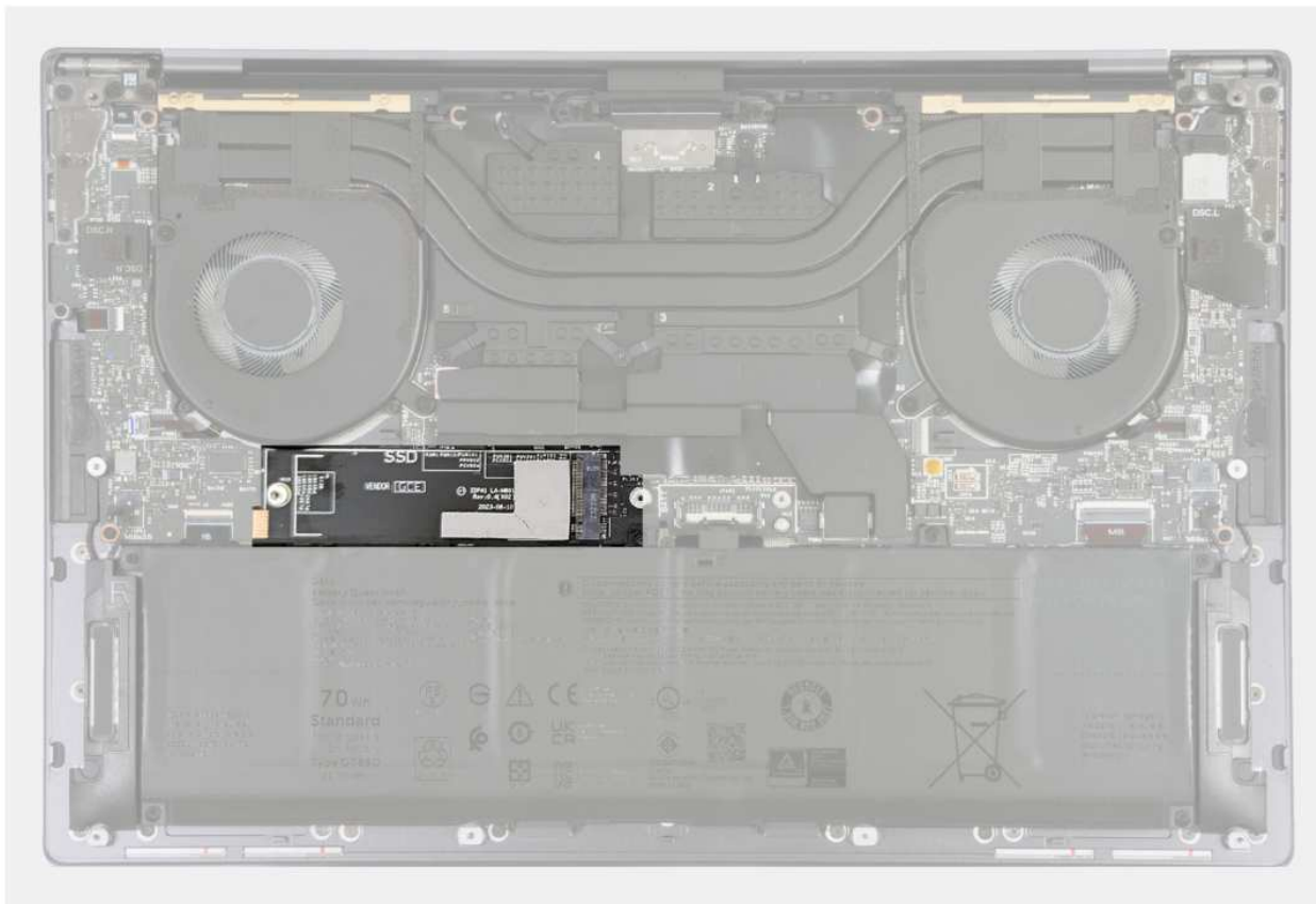
Rysunek 23. Podkładka termoprzewodząca dysku SSD M.2
