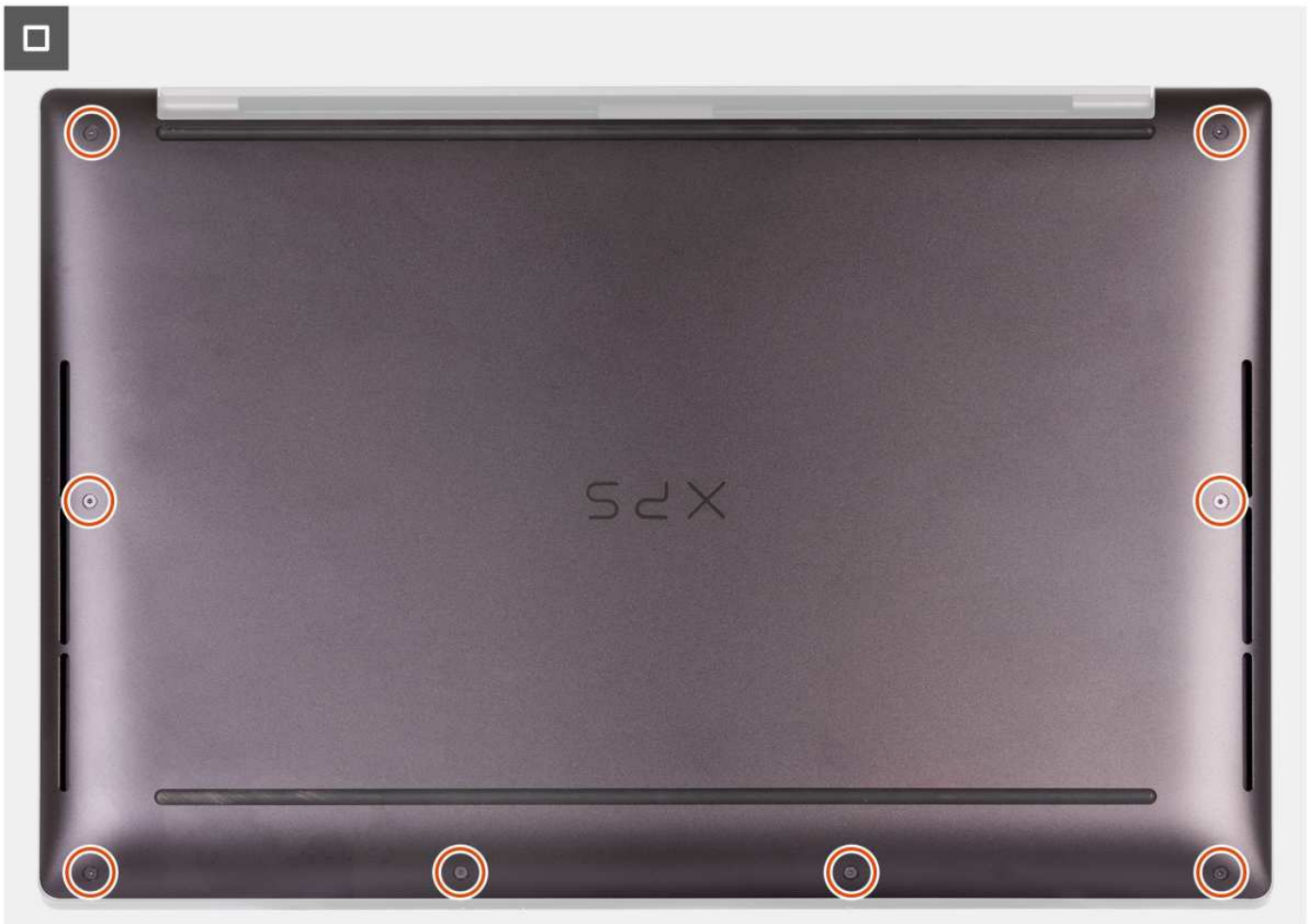
Rysunek 16. Dokręcanie ośmiu śrub mocujących pokrywę dolną do zestawu podpórki na nadgarstek
