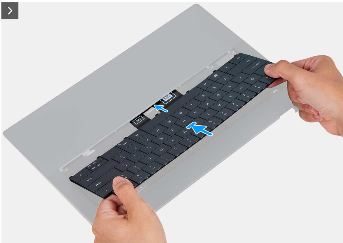
Rysunek 43. Instalowanie klawiatury
