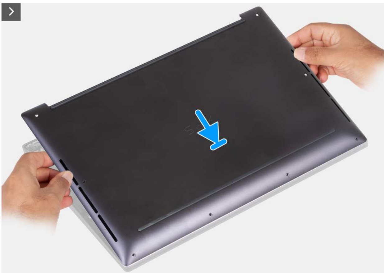
Rysunek 14. Umieszczanie pokrywy dolnej w gniazdach na zestawie podpórki na nadgarstek
