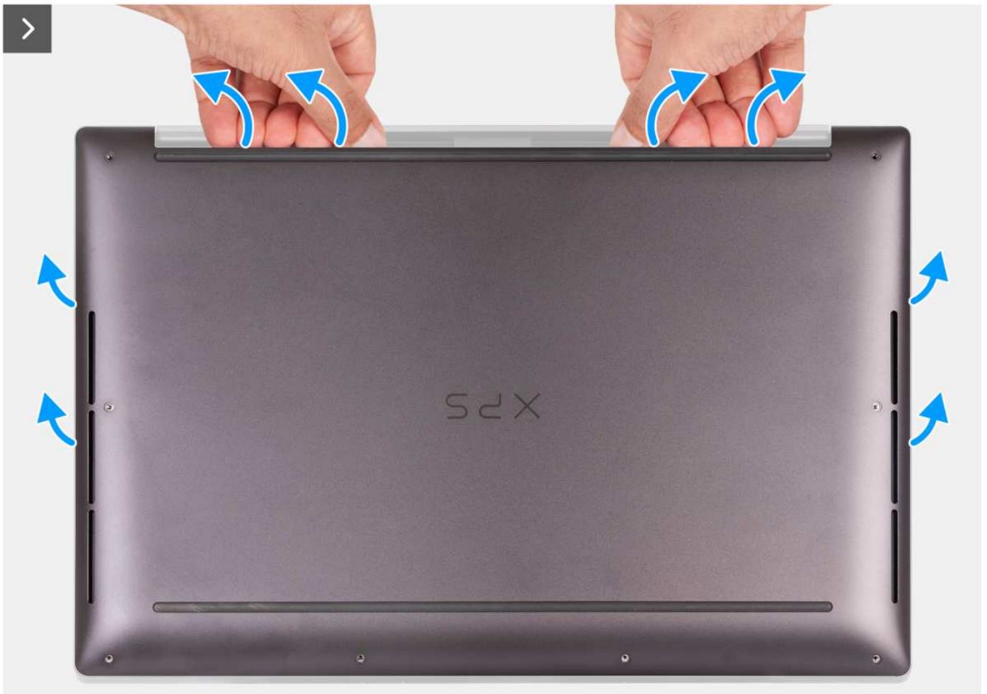
Rysunek 10. Podważanie pokrywy dolnej za pomocą kciuków
