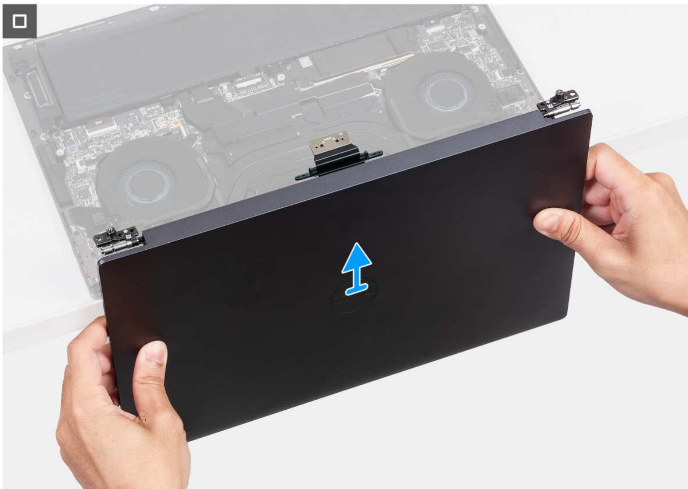
Rysunek 28. Wymontowywanie zestawu wyświetlacza
