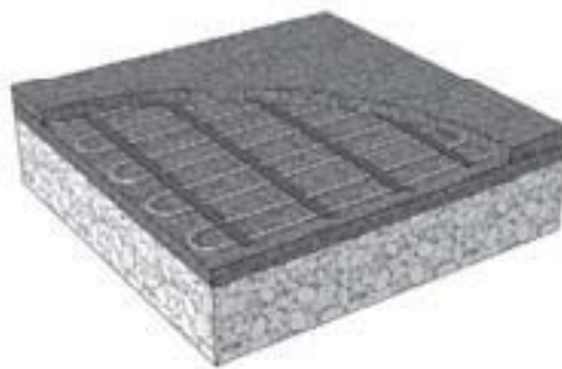
Kabel MA ICE-20 w asfalcie
