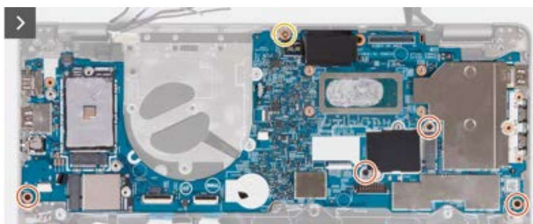
Rysunek 6. Wymontowywanie płyty głównej
