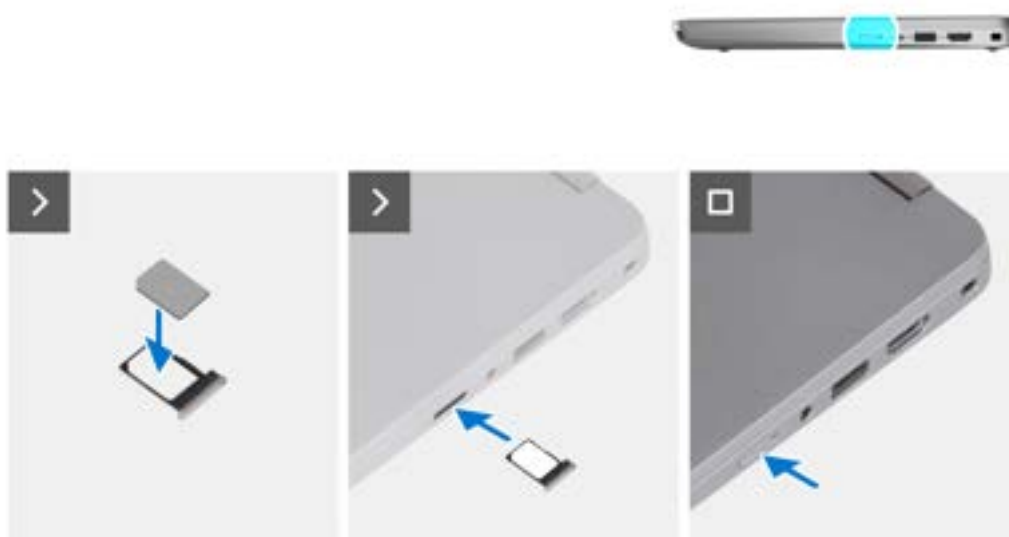
Rysunek 3. Ilustracja: instalowanie tacy na kartę SIM
