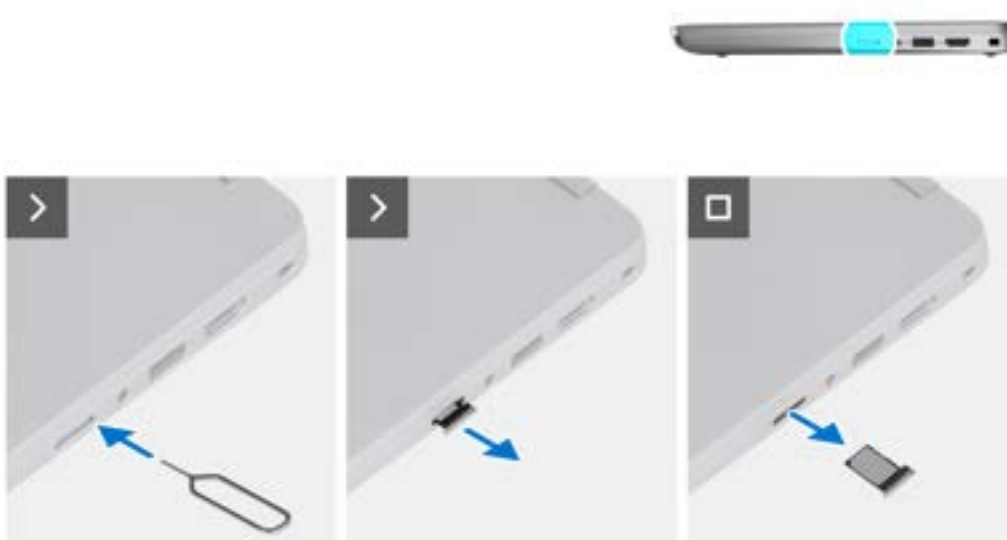
Rysunek 2. Wymontowywanie tacy karty SIM
