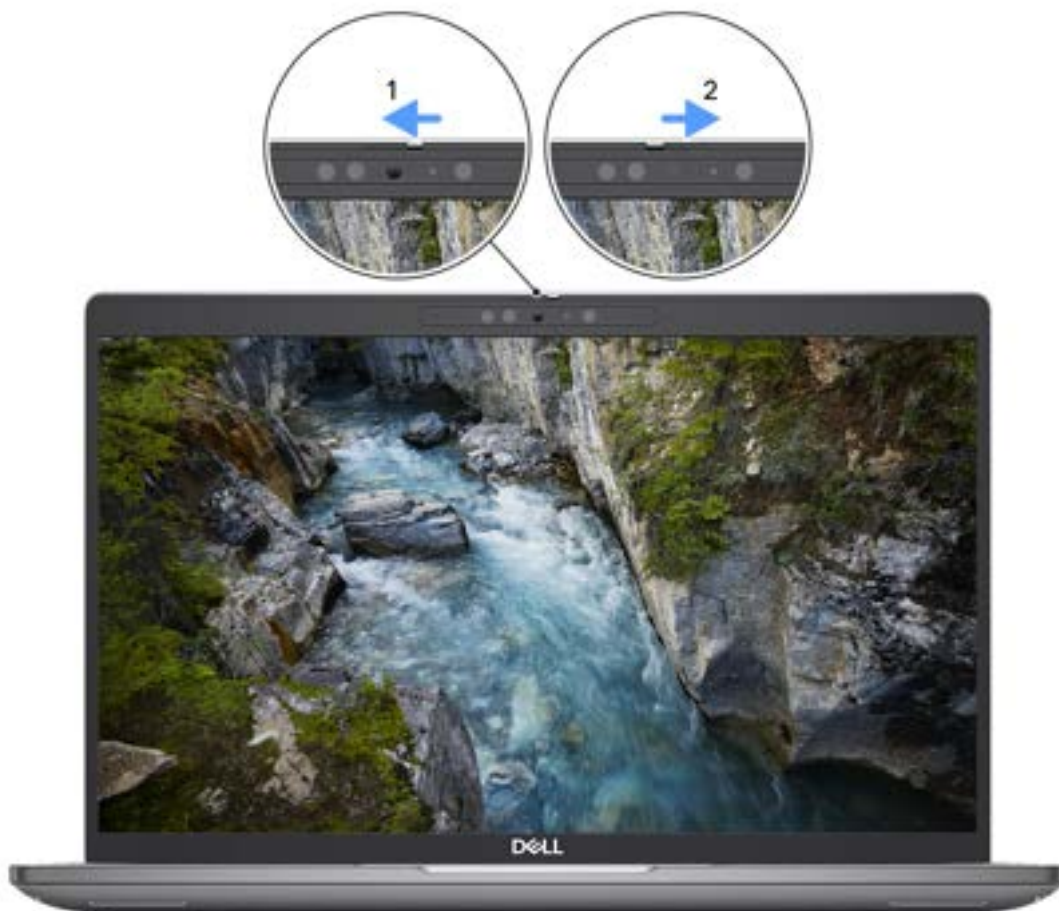
Rysunek 1. Osłona kamery
