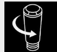
Wykręcanie filtra ze zbiornika wody
