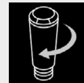
Wkręcanie filtra do zbiornika wody
