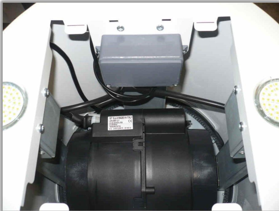
Fot.3 Ulokowanie ceowników mocowania względem dolnego korpusu.
