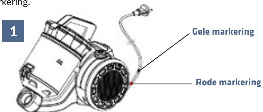
2. Na het aansluiten van de stekker op de stroomvoorziening, druk op de schakelaar
